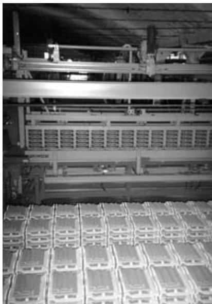
В температурном интервале от 450°С до 600°С происходит отделение химически связанной воды, разрушение глинистых минералов и глина переходит в аморфное состояние. При дальнейшем повышении температуры выгорают органические примеси и добавки, а керамическая масса безвозвратно теряет свои пластические свойства.
